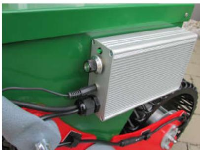
Die Geschwindigkeit des drehmomentstarken Motors ist über den Controller stufenlos regelbar.
