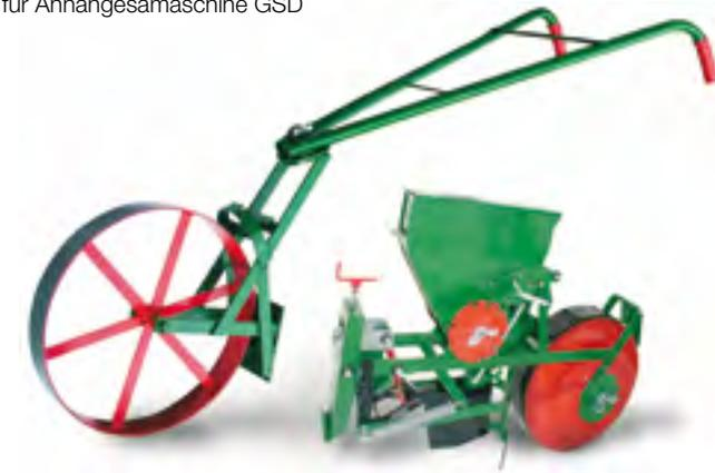
Durch Verwendung des Fahrgestells FG ergibt sich eine Handsämaschine einreihig für kleinere Einsaatflächen, die den Einsatz eines mehrreihigen Gerätes nicht lohnen bzw. nicht möglich ist (z.B. an Ackerrändern).
