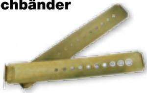
Die Sämaschinen sind präzise und schnell über Lochbänder einstellbar. Zwei Lochbänder gehören zur Standardausrüstung bei Handsämaschine HS, sowie bei Anhängesämaschine GSD.
